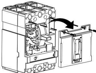
Снять вспомогательную крышку
