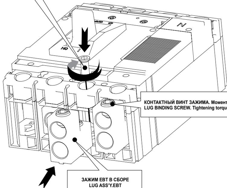
КОНТАКТНЫЙ ВИНТ ЗАЖИМА. Момент затяжки: 367~428 кгс\*см
