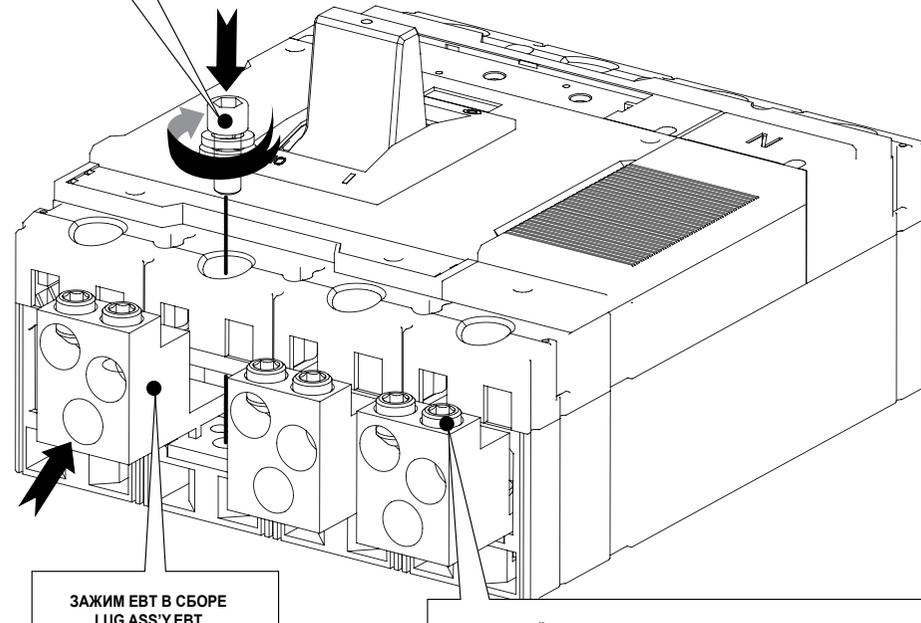
КОНТАКТНЫЙ ВИНТ ЗАЖИМА. Момент затяжки: 367~428 кгс\*см
